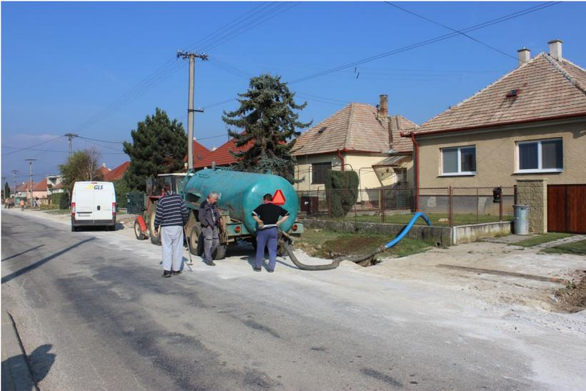
Bisher sammelte die Bevölkerung der acht Gemeinden, die vom Erweiterungsbeitrag unterstützt wurden, sanitäres Abwasser vor allem in septischen Tanks. Die septischen Tanks wurden regelmässig abgepumpt und die Abwässer auf der Strasse in entfernte Kläranlagen gefahren. © SECO
